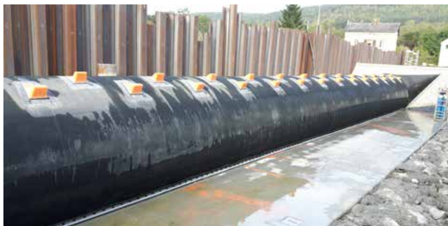
Test de gonflage à l'air de la bouchure.
